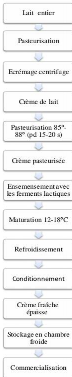
Figure 10: Diagramme de fabrication de la crème fraîche épaisse (selon LE LITTORAL GIPLAIT).
