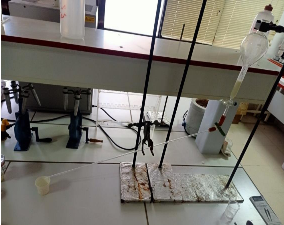
Figure13. Dispositif de mesure de la viscosité du yaourt.
