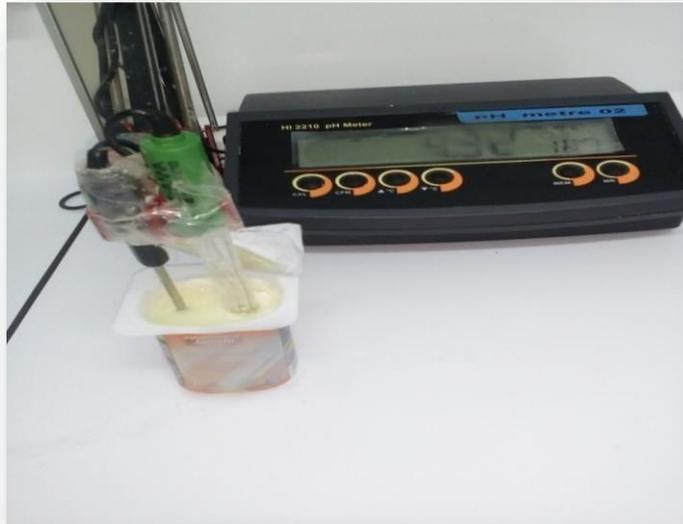
**Figure 06 :** Détermination du pH par un pH-mètre
