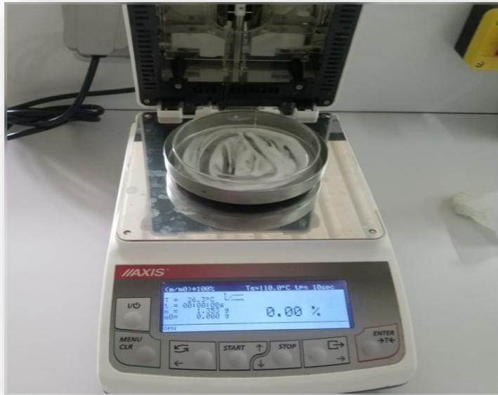
**Figure 08** : Détermination de l'extrait sec total par un dessiccateur
