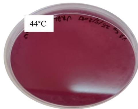
**Figure 15 :** absence de colonies des Coliformes fécaux sur milieu VRBL
