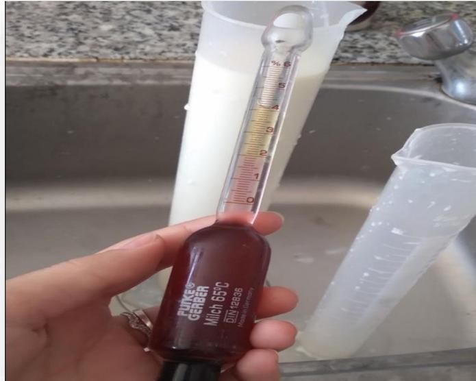
**Figure 09 :** Détermination de la teneur en matière grasse
