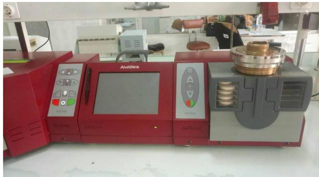
**Figure N°5. Appareil Alvéographe CHOPIN (AFAK Control -Oran-, 2021)**
