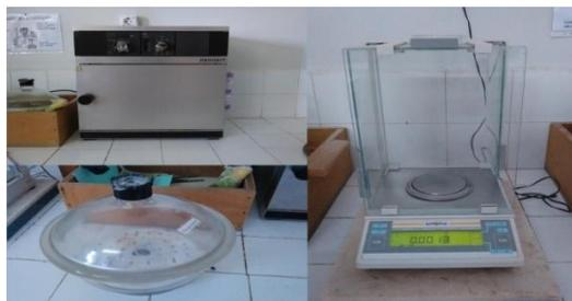
**Figure N°13: dosage de d'humidité (ERIAD, 2021)**
