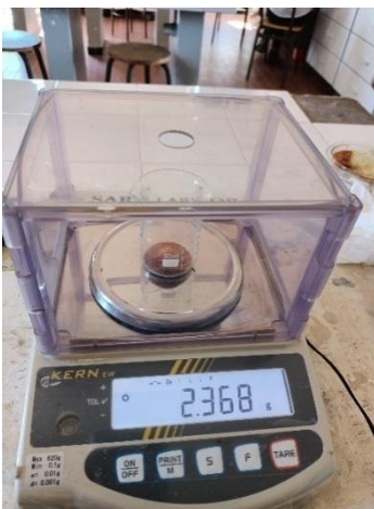
Figure 20 : la peser du creuset avant et après sortie du four à moufle
