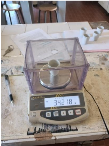
Figure 20 : la peser du creuset avant et après sortie du four à moufle
