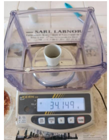
Figure 20 : la peser du creuset avant et après sortie du four à moufle
