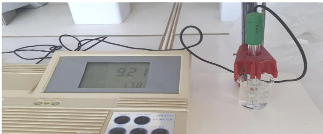
Figure 21 : Mesure du pH de l'albumen.
