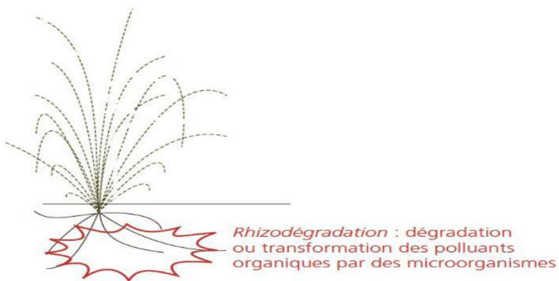
Figure .17. Fonctionnement de la rhizodégradation (Bert et al. , 2012)
