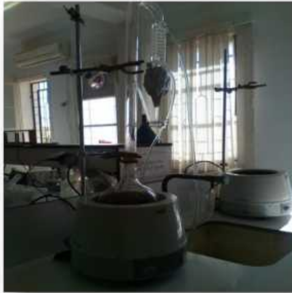
Figure 14. Montage d'hydro distillation de type Clevenger.
