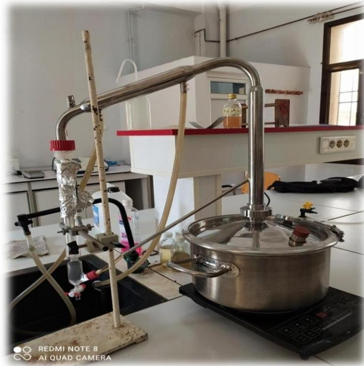
Figure 12 : Dispositif d'extraction des HEs par hydrodistillation.
