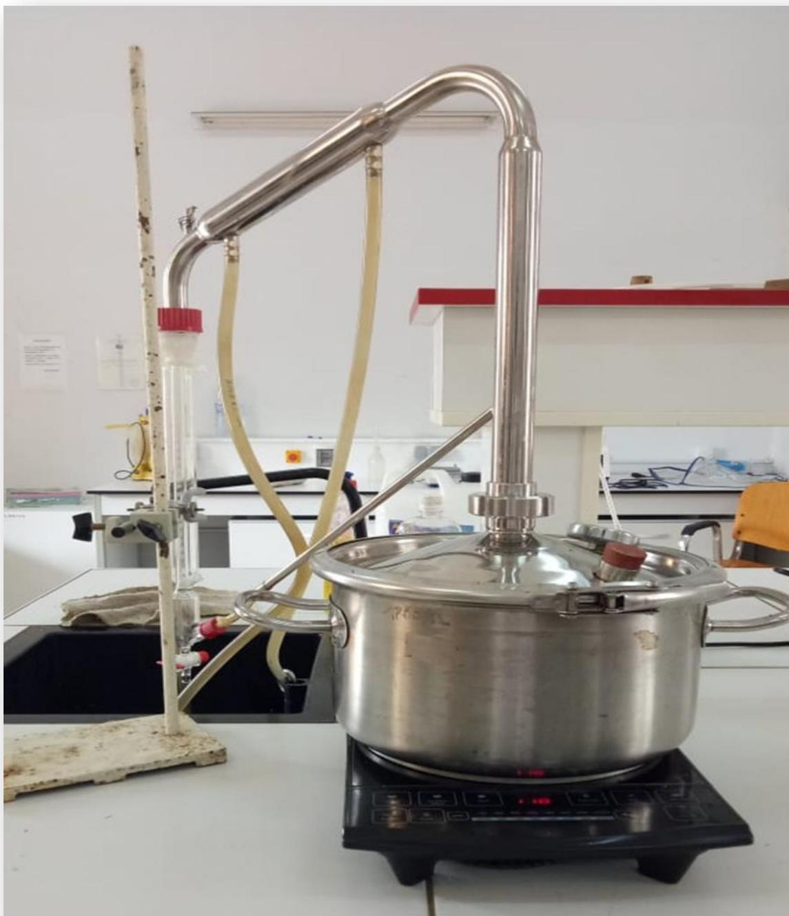
**Fig. 17** : Appareil de Clevenger (Originale, 2021).
