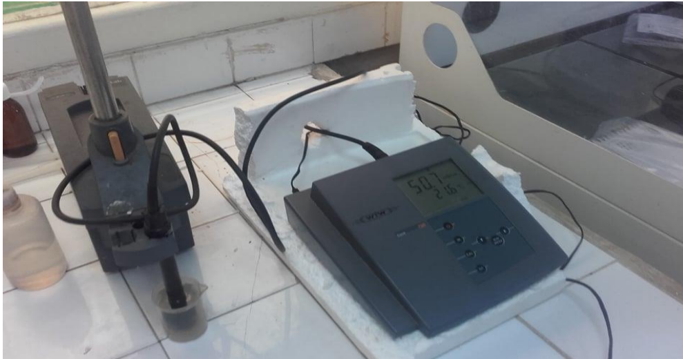
Figure n°20 : conductimètre (photo prise au niveau de la station de dessalement de Marsat El Hadjadj2021)
