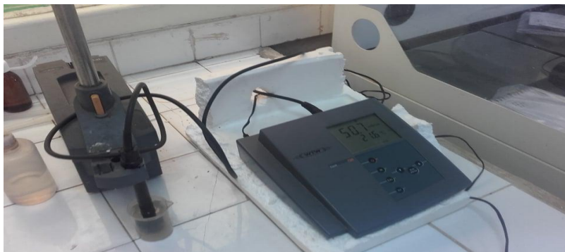
Figure 10 : mesure de température par conductimètre
