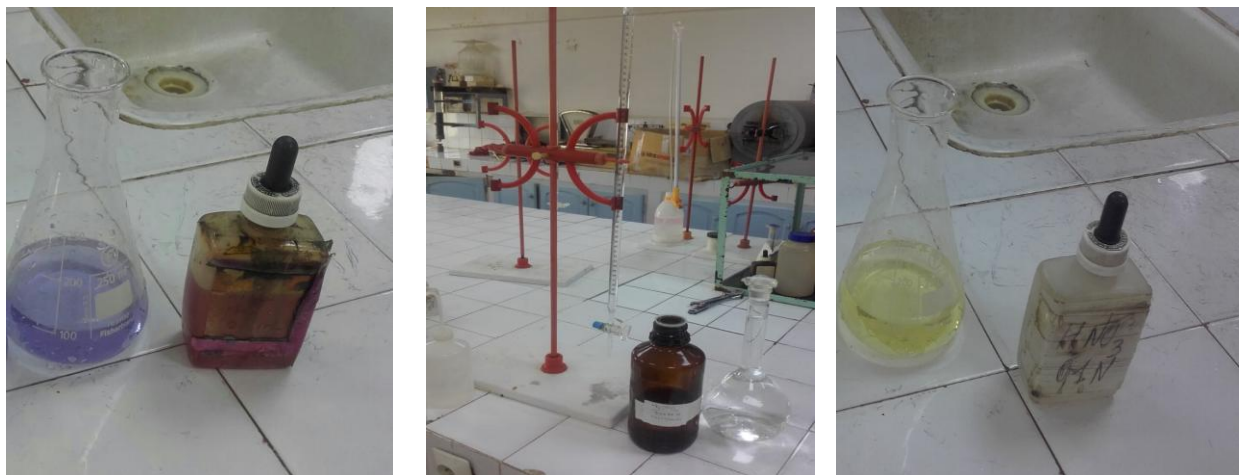
Figure 14 : les solutions et Matériel utilisé pour détermine la valeur de chlorure
