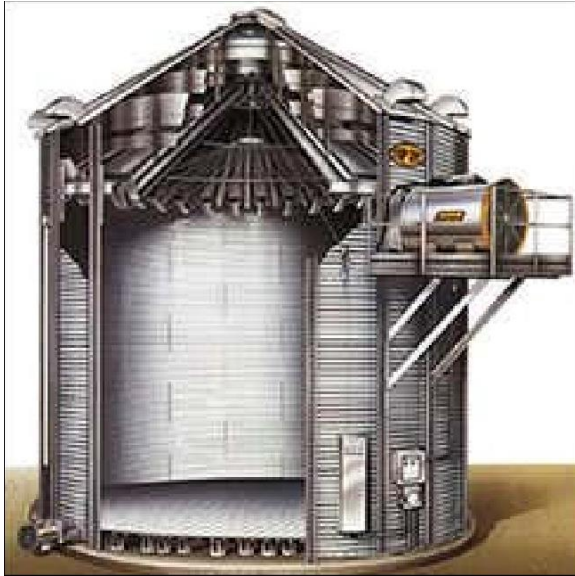
Figure 08: image montrant l'intérieure d'un silo métallique (Hatice, 2016).
