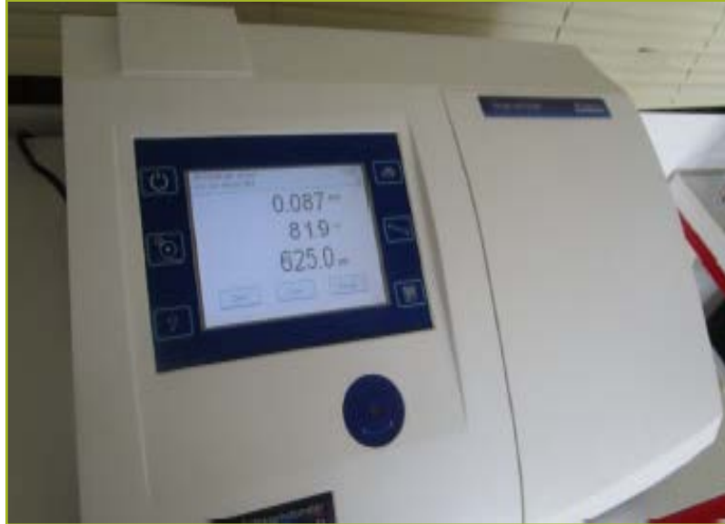
Figure 15 : Lecture de la densité optique des suspensions bactériennes sur un spectrophotomètre ( photo originale 2021 )
