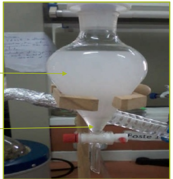
Figure 18 : Etapes de séparation des phases de distillat (photo originale 2021).
