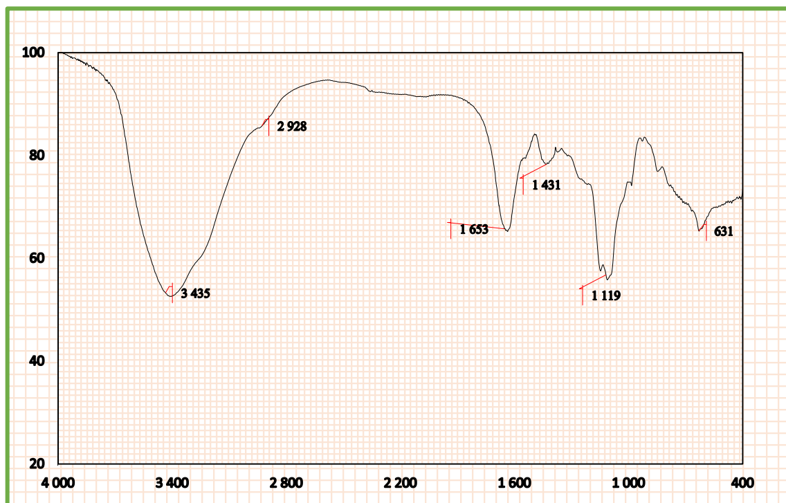
Figure 9. Spectre IFTR de l' Ulva Lactuca traitée à 105°C(U105)
