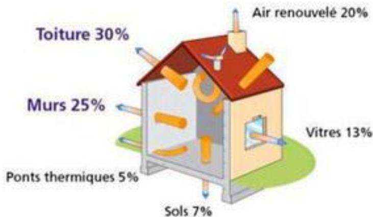
Figure 5:schémas des déperditions thermiques
