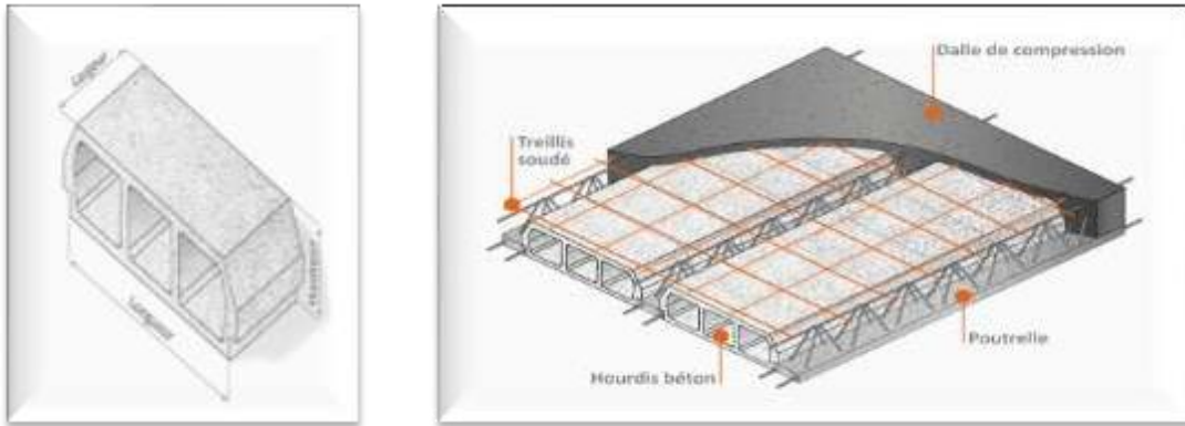
Fig.II.2 : Schéma descriptif d'une dalle à corps creux.
