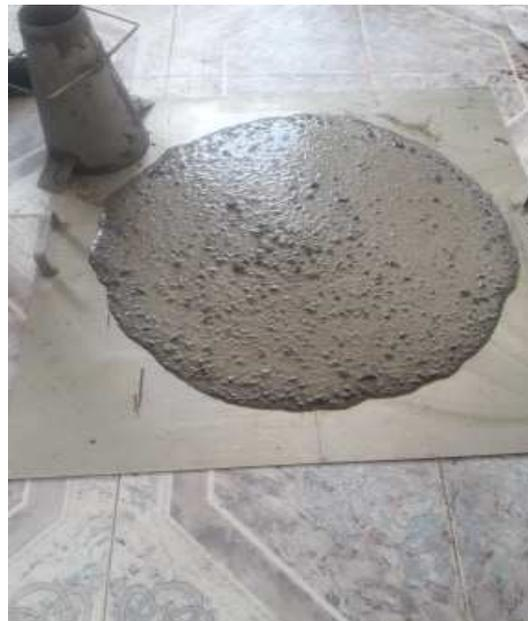
Figure I.3 : Photo de la galette de BAP réalisée au laboratoire.
