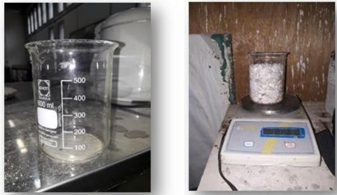
**Figure III.5 : Mesure de la masse volumique apparente du gravier.**
