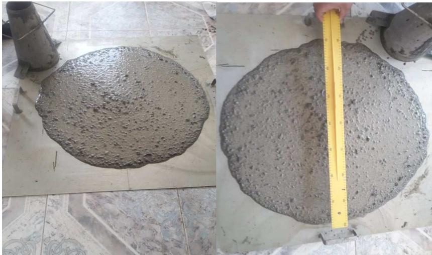
**Figure III.11 : Essai d'étalement.**
