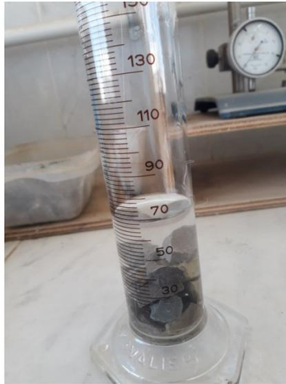
**Figure III.6 : Mesure de la masse volumique absolue du gravier.**
