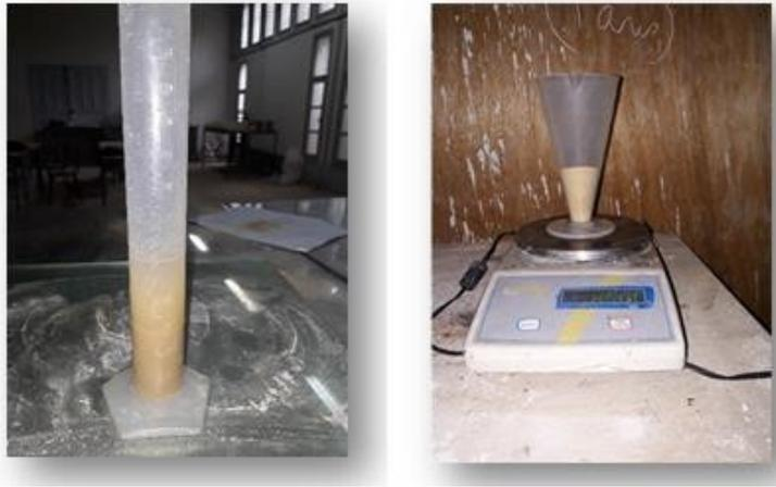
Figure III.2 : Mesure de la masse volumique absolue du sable.
