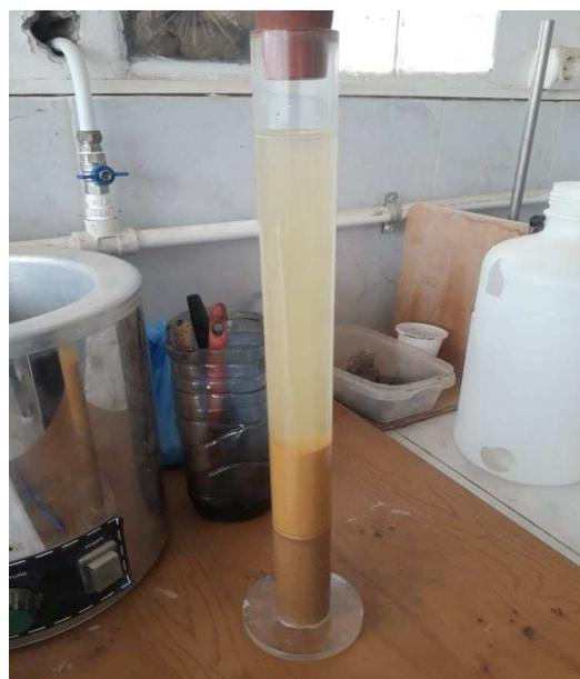
Figure III.4 : Mesure de la propreté du sable.
