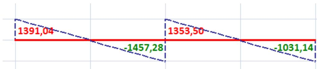
Figure III.10 : Diagramme des efforts tranchants à l'ELU du 3<sup>ème</sup> type de poutrelle.
