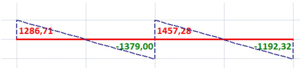
Figure III.6 : Diagramme des efforts tranchants à l'ELU du 2<sup>ème</sup> type de poutrelle.
