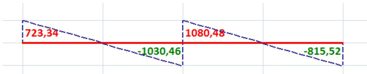
Figur III.7 : Diagramme des efforts tranchants à l'ELS du 2<sup>ème</sup> type de poutrelle.
