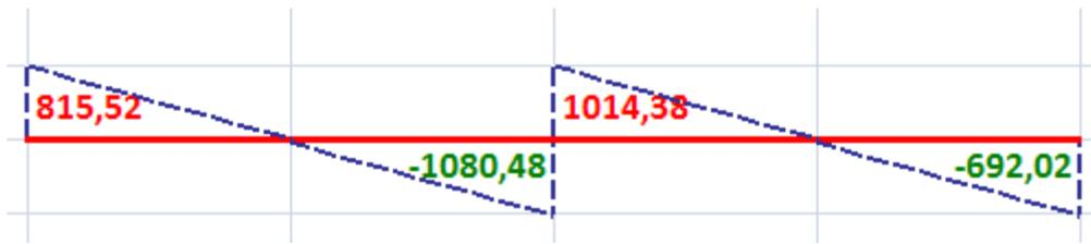
Figure III.11 : Diagramme des efforts tranchants à l'ELS du 3<sup>ème</sup> type de poutrelle.
