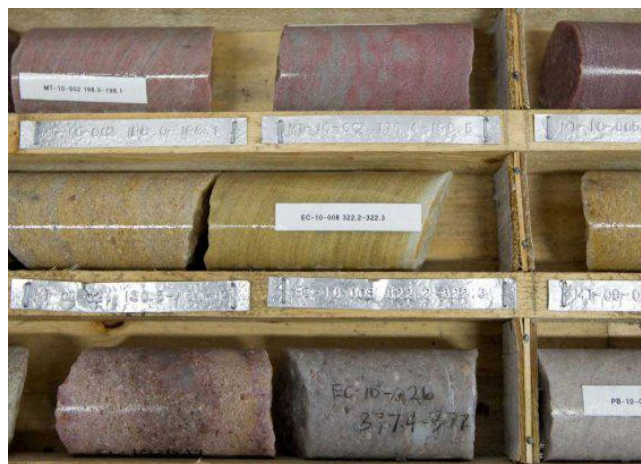
Figure n°48 : Exemple d'un essai de carottage.
