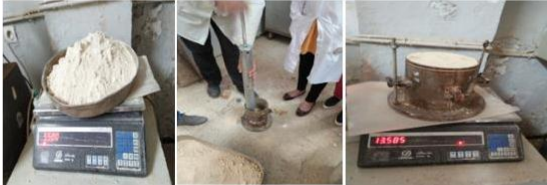
Figure n°43 : les étapes de l'essai Proctor.
