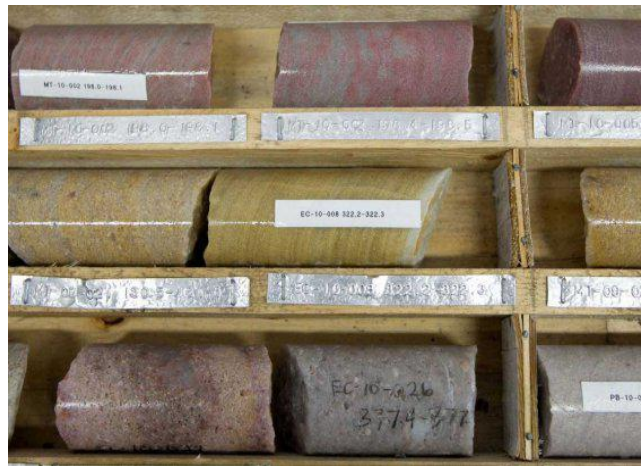
Figure n°47 : exemple d'un essai de carottage.
