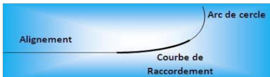
Figure n°17 : Élément du tracé en plan.
