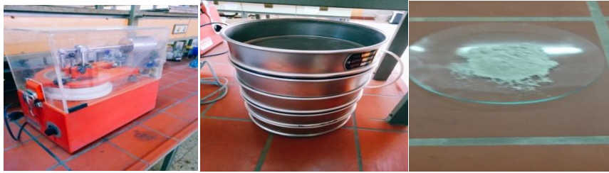
Figure II.2. Préparation de l'argile : broyage et tamisage
