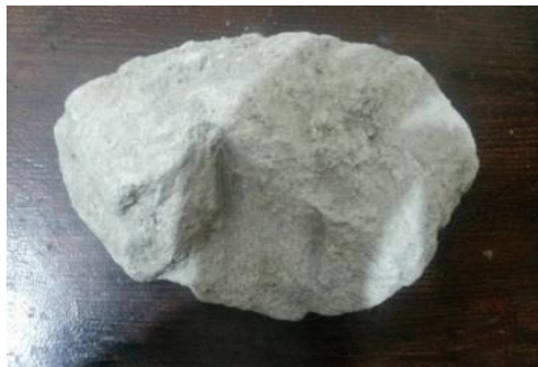
Figure II.1. Argile brute sous forme d'une roche
