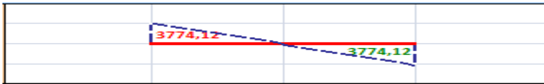
Figure 3. 21 : Diagramme des efforts tranchants
