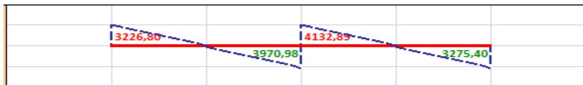
Figure 3. 5 : Diagramme des efforts tranchants
