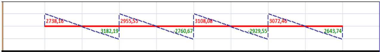
Figure 3. 9 : Diagramme des efforts tranchants
