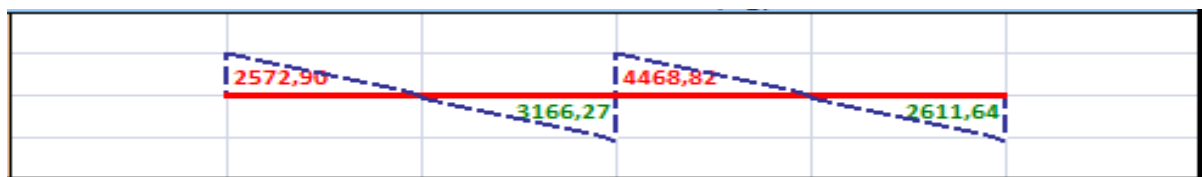
Figure 3. 3 : Diagramme des efforts tranchants
