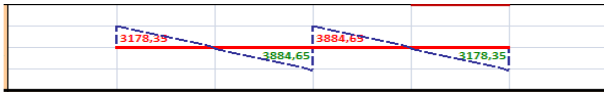
Figure 3. 29 : Diagramme des efforts tranchants
