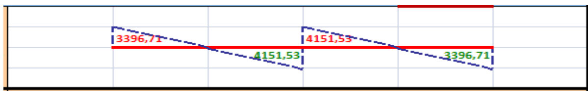
Figure 3. 17 : Diagramme des efforts tranchants
