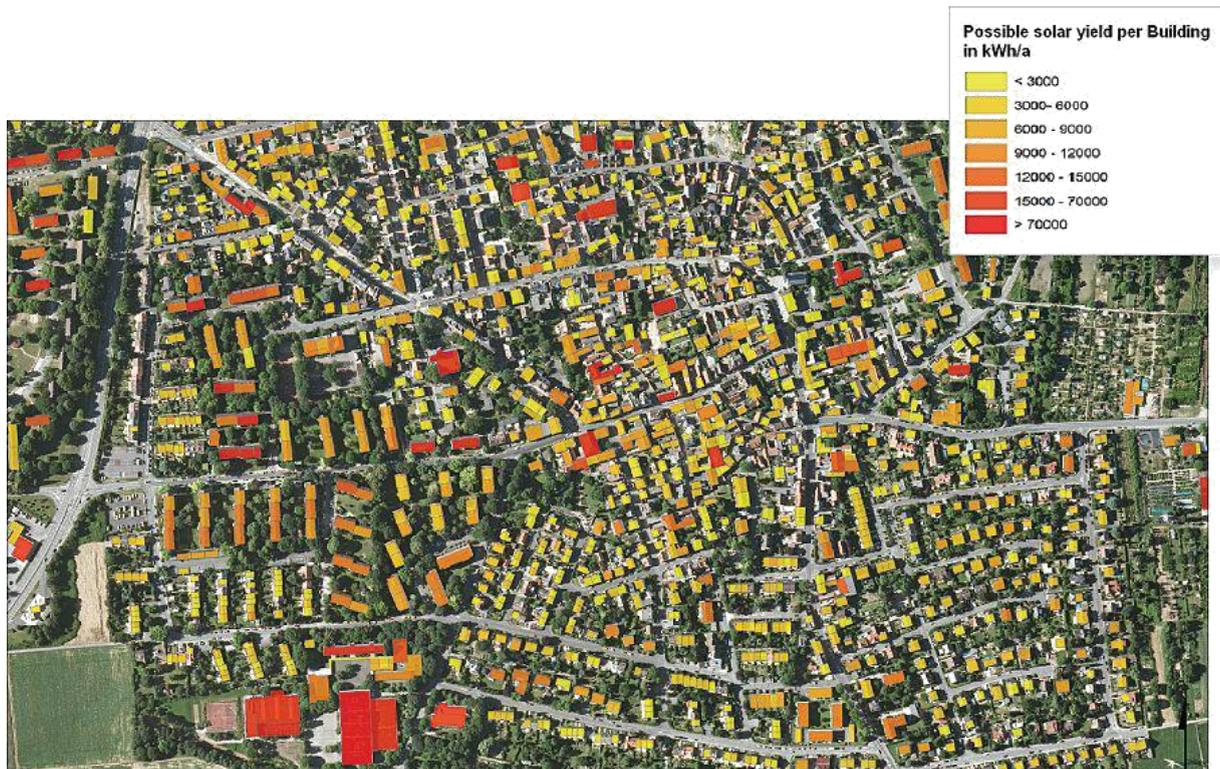
FIGURE III-5 : EXEMPLE D'ÉVALUATION DU POTENTIEL SOLAIRE DES TOITURES DE BÂTIMENTS
