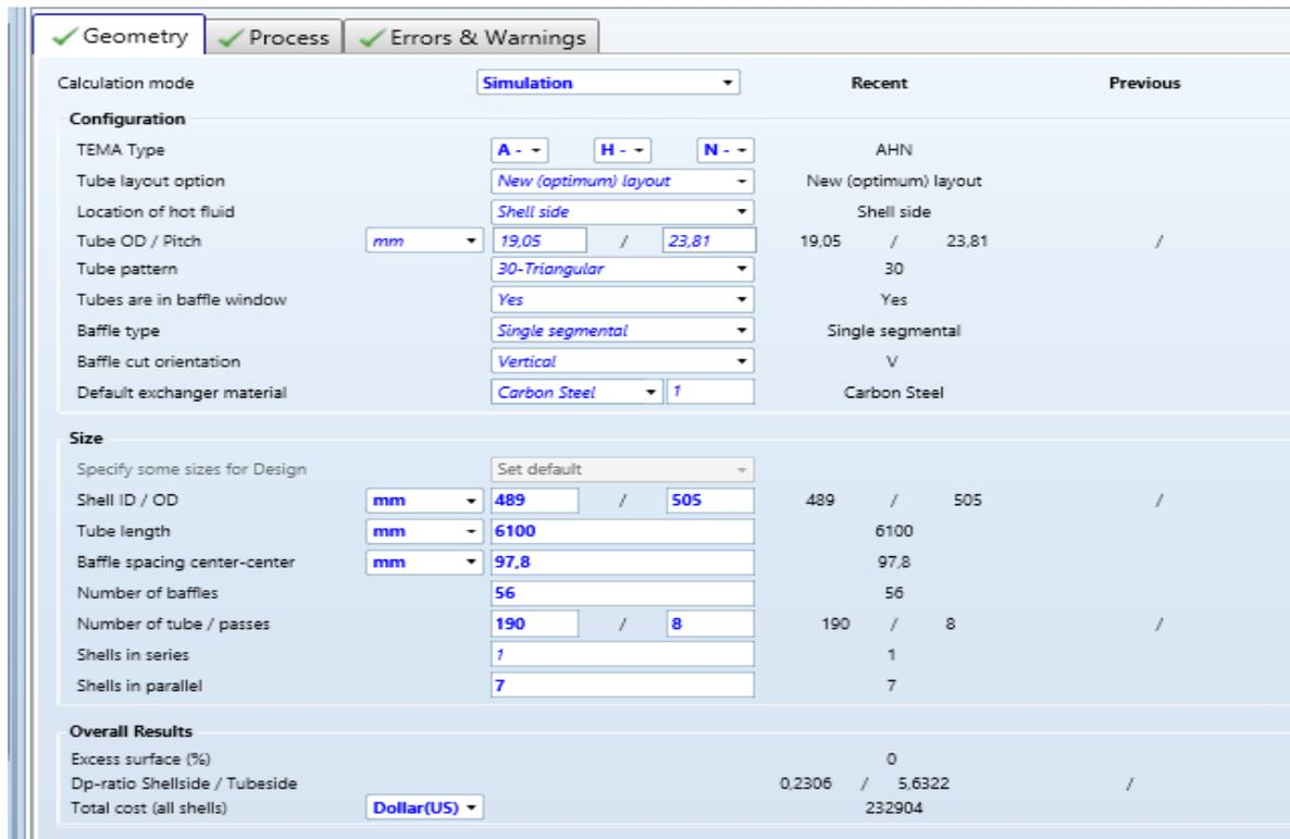
Figure 1 : Définition de la géométrie de l'échangeur
