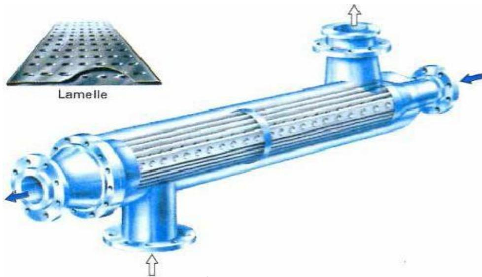
Figure 8 : Échangeur lamellaire [8]
