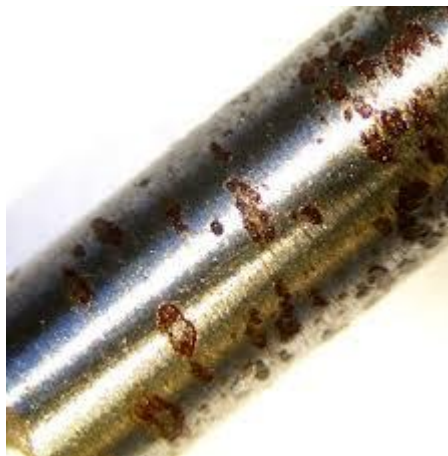
Figure 2.8: La corrosion par piqures
