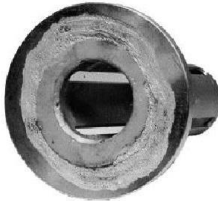
Figure 2.9: La Corrosion par crevasse sous un joint
