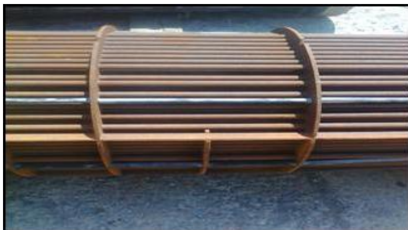
Figure 3.3: L'effet de la MEA sur la surface des tubes d'échangeur E504
