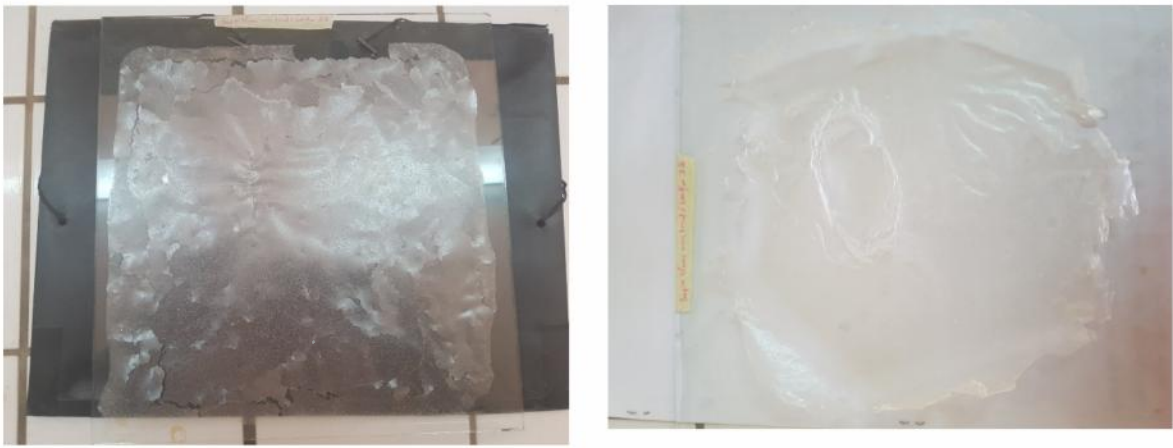
Figure 20 : photos de film cassant et gluant
