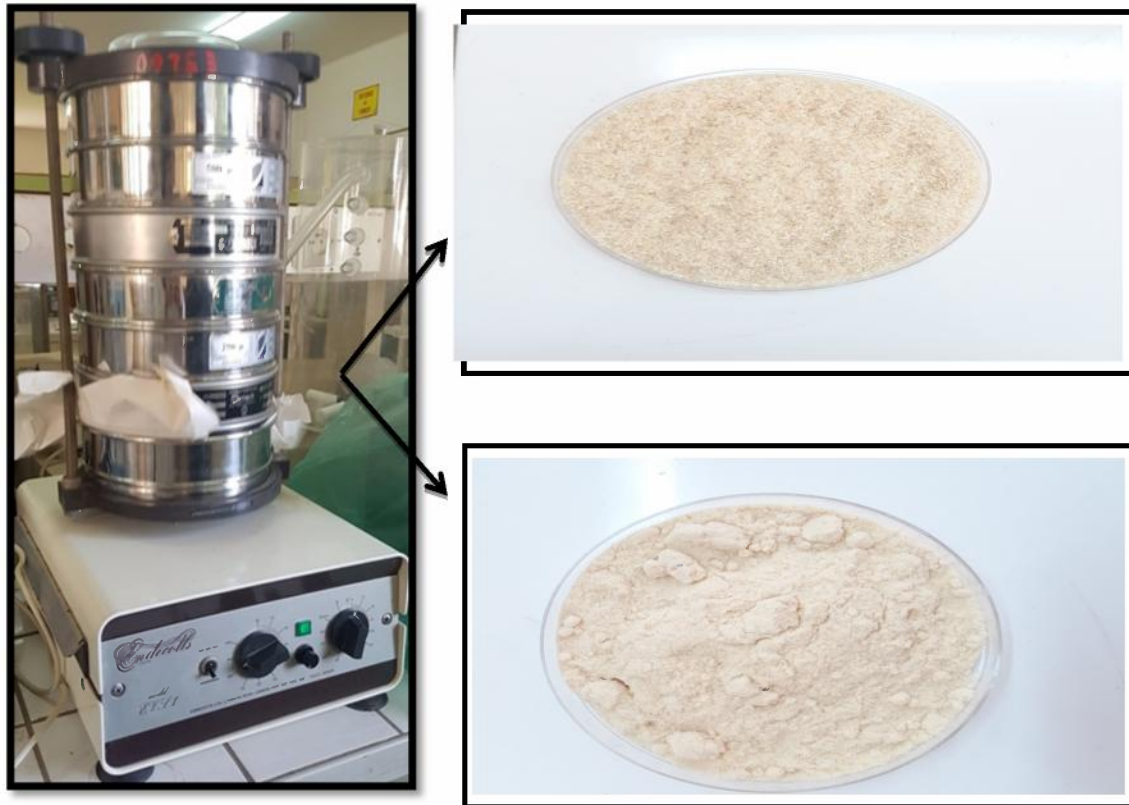
Figure 13-a: tamisage de la farine de Abies Alba Figure 13-b: Fibre brute 500 et 200 \mu\text{m}
