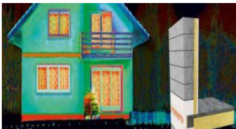
Figure 21: Exemple sur les ponts thermiques (en orange).
