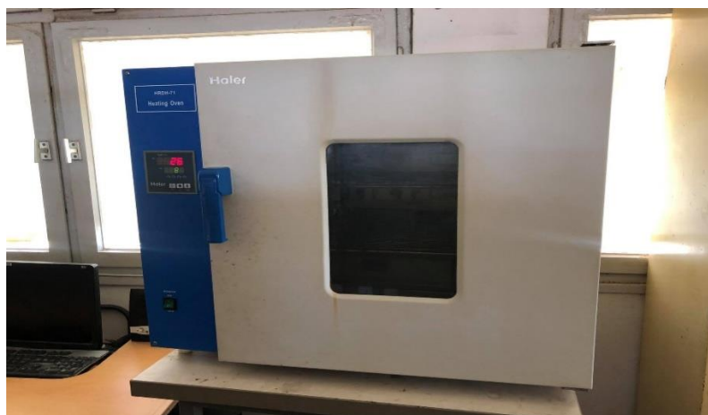
Figure III.5: Etuve Haier HRDH-71 heating oven utilisée.
