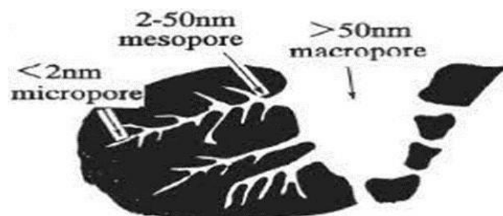
Figure I.1 : Représentation schématique de la texture poreuse d'un charbon actif.
