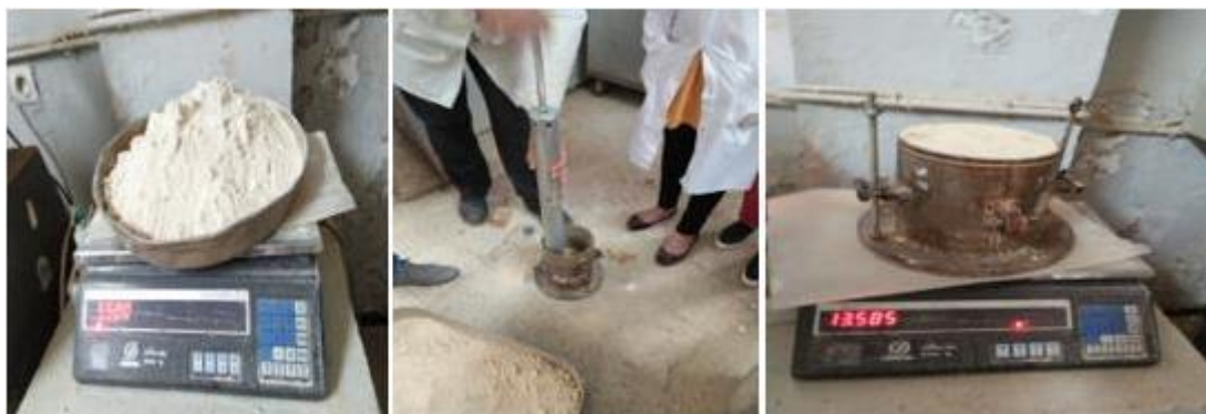
Figure n°46 : les étapes de l'essai Proctor.
