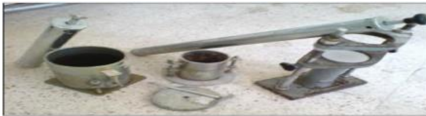
Figure n°45 : Matériels de l'essai Proctor.
