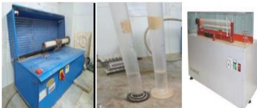
Figure n°36: Matériels utilisés dans l'essai équivalent de sable.
