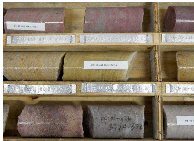
Figure n°50 : exemple d'un essai de carottage.
