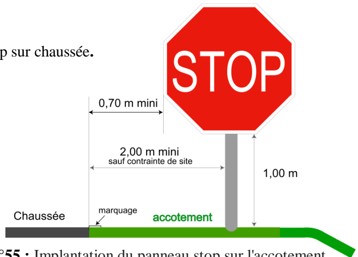
Figure n°55 : Implantation du panneau stop sur l'accotement
