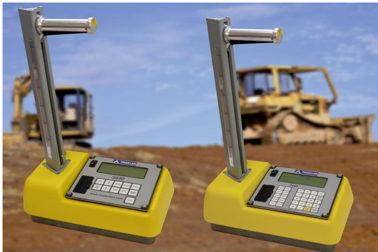
Figure n°49 : L'appareil de compacité (nucléo-densimètre).
