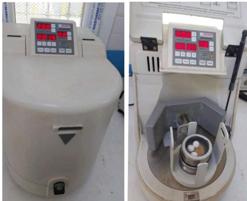
Figure III.2 : Broyage du sable à l'aide d'un broyeur à bille
