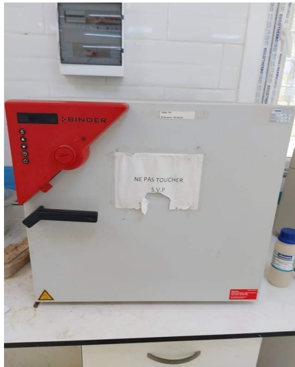
Figure III.1: L'étuve utilisé pour sécher le sable
