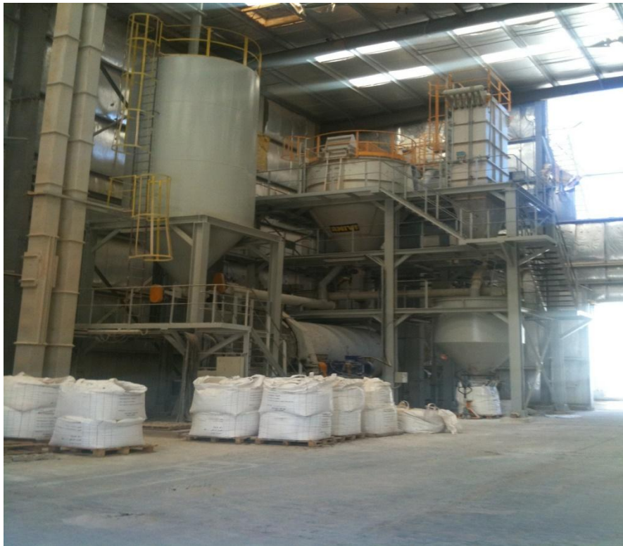
Figure I.12 : Station de broyage du sable
