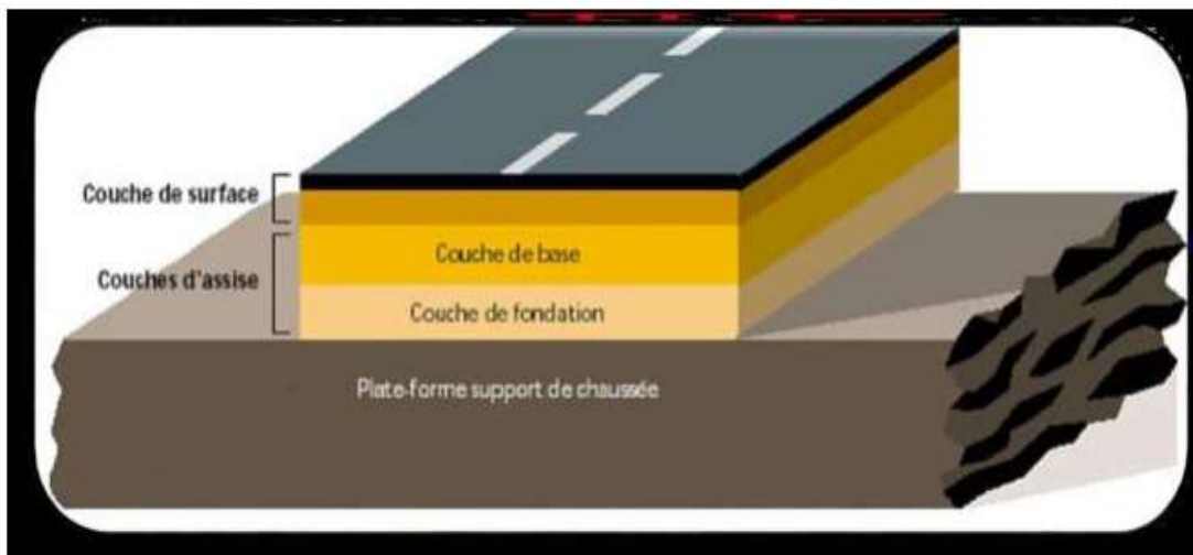
Figure II.1 : Les chaussées souples
