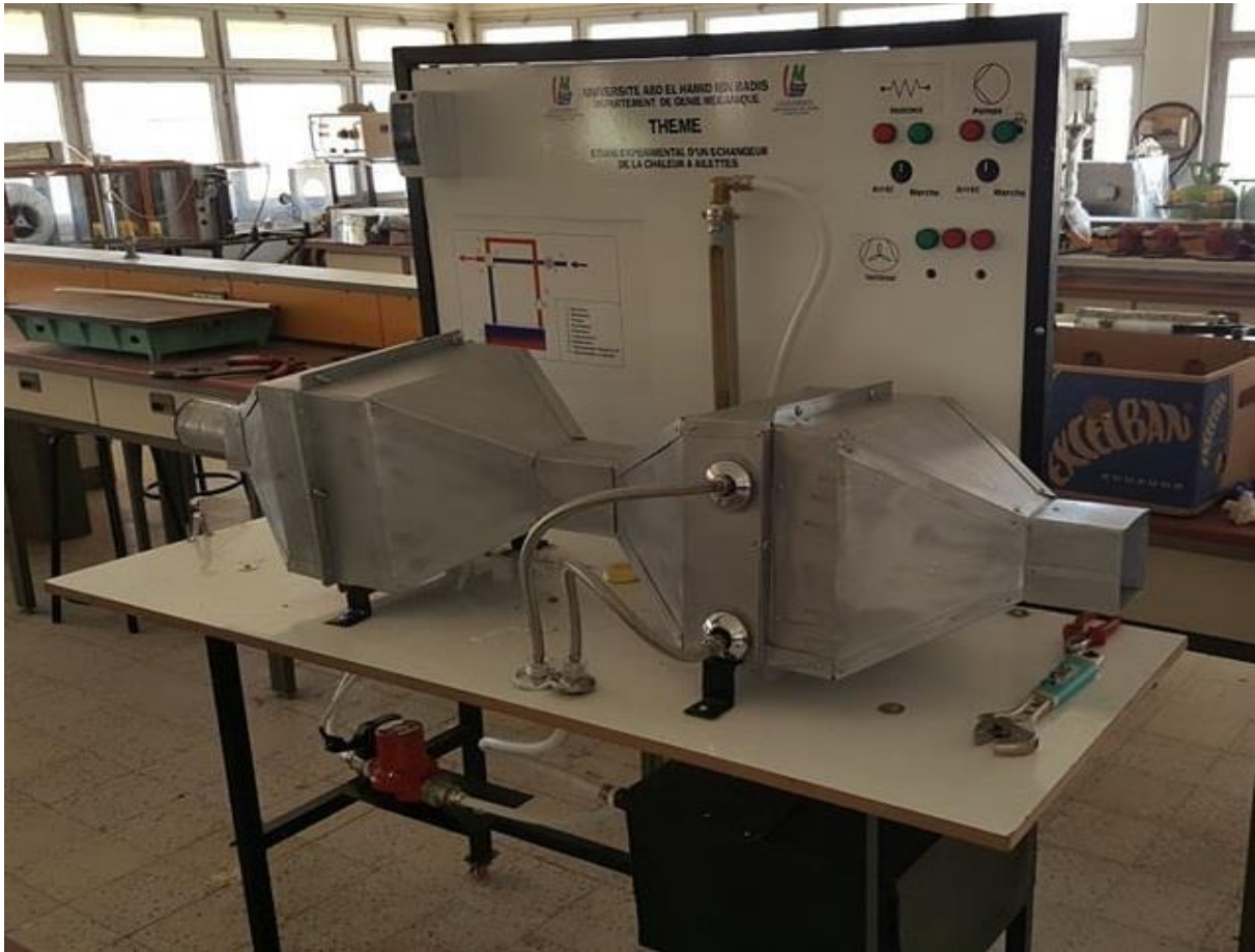
Figure II.8: Banc d'essai expérimental d'échangeur de chaleur à ailettes
