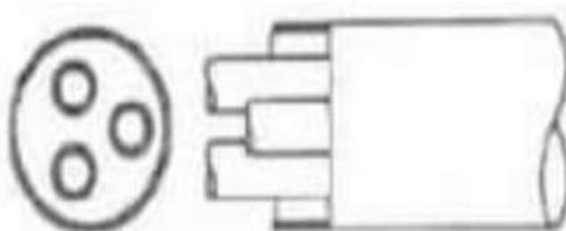
Figure I.9 : Échangeur à tube séparés.
