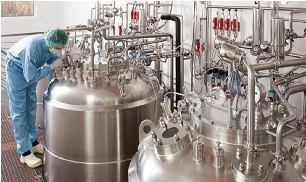
**Figure 20.** Le réacteur fermé de la fabrication du rouge à lèvres
