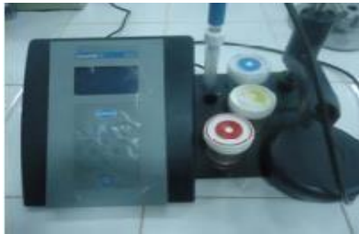
Figure II.1. pH mètre (HACH)
