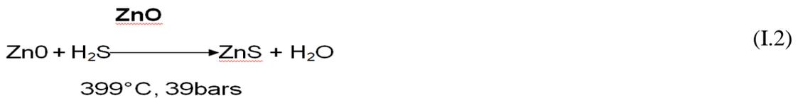
A la sortie de cette section, la teneur en soufre est inférieure à 0,25 ppm. Notons que le catalyseur ZnO occupe un volume de 09.9 m<sup>3</sup> et absorbe jusqu'à 18% en poids de soufre et le catalyseur Co/Mo occupe un volume de 06 m<sup>3</sup>. Rappelons aussi que le gaz naturel algérien est naturellement désulfuré.
