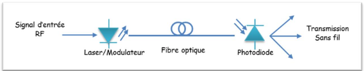
Figure II.3 : Schéma synoptique d'une liaison RoF.
