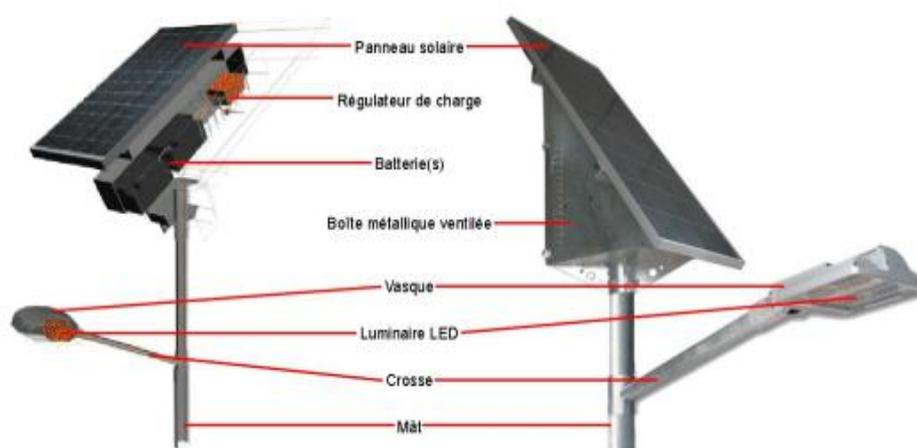
**Figure 1.11 :** *Les composantes d'un lampadaire solaire isolées [11]*
