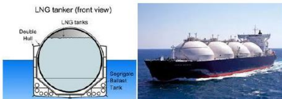
Figure. I.8 : Méthanier avec cavités sphériques autoportées [11]
