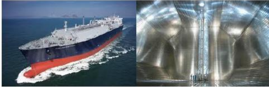
Figure. I.7 : Méthanier à membrane [11]
