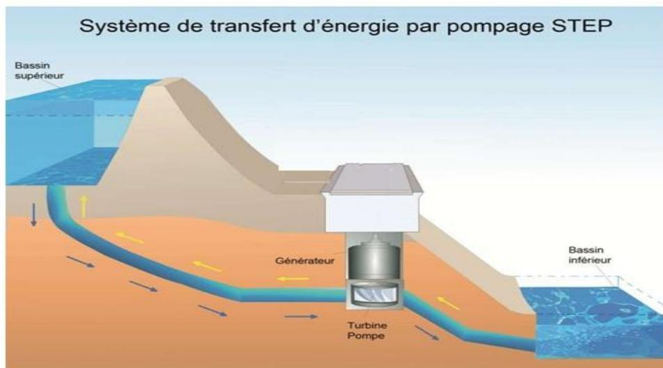
Figure II. 2 : système de transfert d'énergie par pompage STEP [9]
