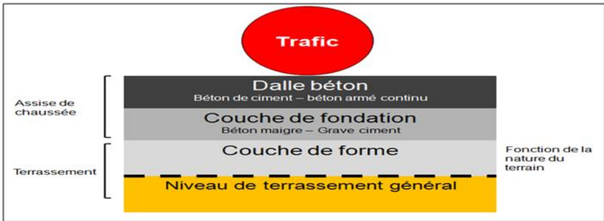
Figure VII.3 : Structure type d'une chaussée rigide.
