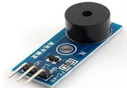
Figure 2. 11 : Module Buzzer
