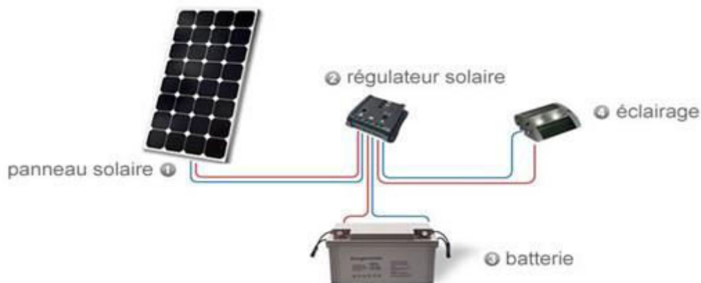
Fig. III.11 Modèle d'installation PV avec régulateur MPPT
