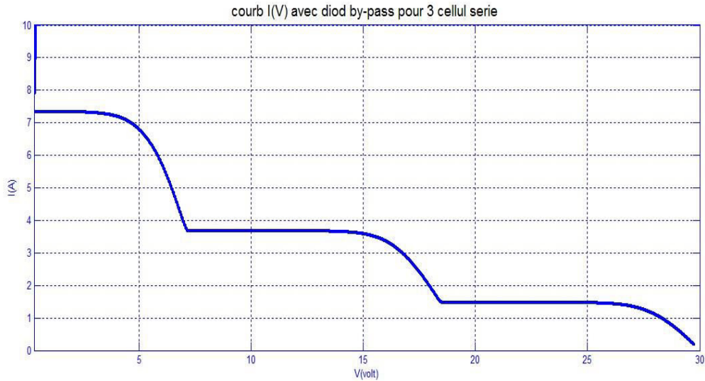
Fig. IV.11 Caractéristiques (I-V) d'un générateur photovoltaïque sous l'effet d'ombrages partiels avec diodes by-pass.
