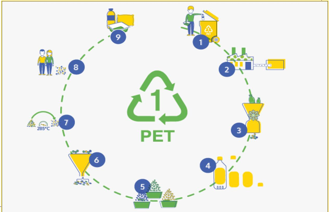
Figure II.14 : les étapes de recyclage des bouteilles plastiques.
