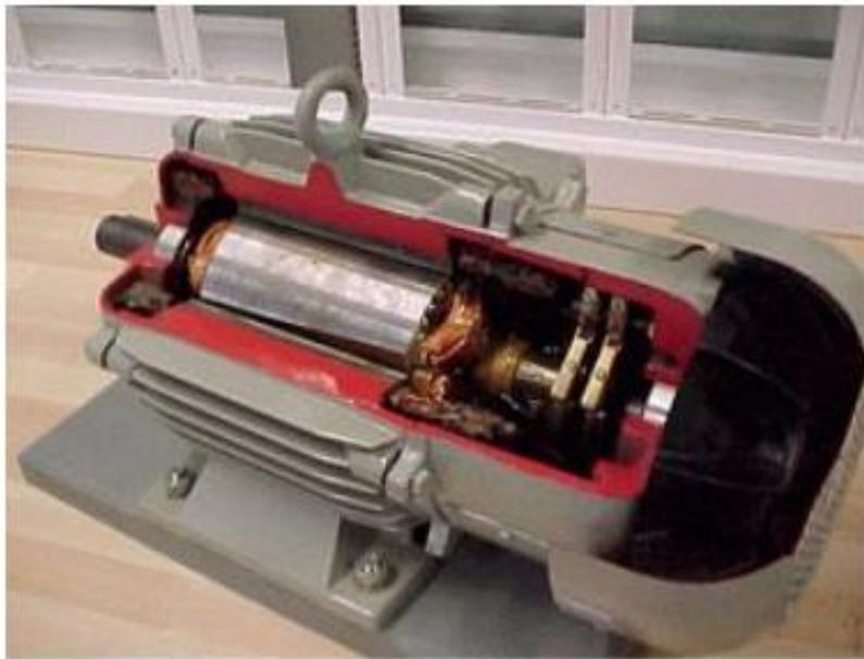
Figure III.6 : Machine synchrone
