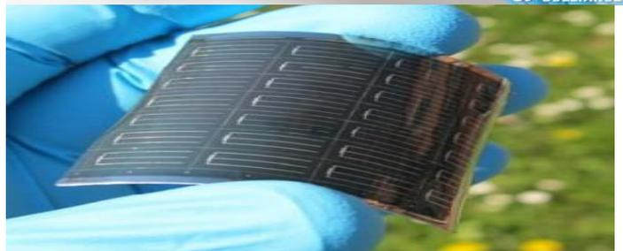
**Couche mince de tellure de cadmium** : Ce modèle de cellule photovoltaïque est composé lui aussi à partir d'un matériau autre que le silicium. Ici, c'est du tellure de cadmium qui est employé en une seule couche scellée entre deux plaques de verre
