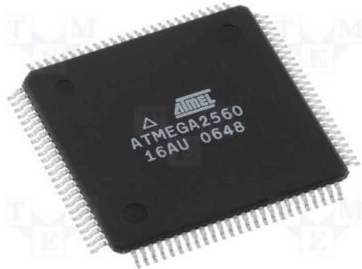
Fig.2 : Carte microcontrôleur ATmega2560
