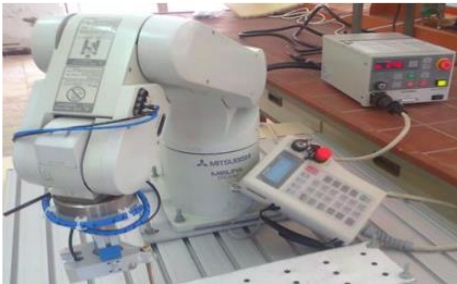
Figure II.9: boîte à boutons pour l'apprentissage du robot.
