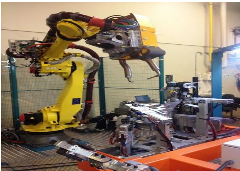
Figure II.1: Robot industriel du soudage par points [22].
