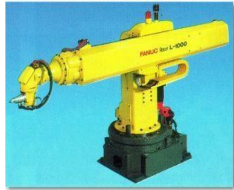
Figure I. 10: Robot sphérique (Fanuc) [28].
