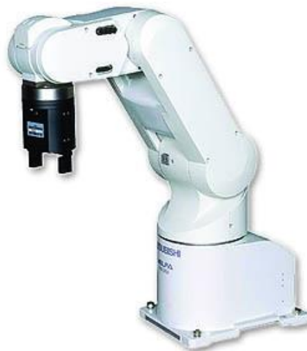
Figure I.1 : Robot sériel (Robot RV-2AJ de Mitsubishi).
