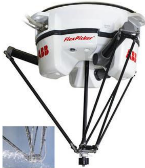
Figure I.2 : le Robot parallèle (FlexPicker ) dédié aux applications alimentaires du type « Pick& Place » [9]
