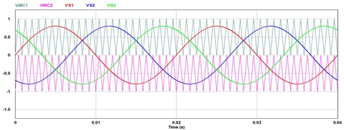
Figure III 20: les signaux d'entrés pour la modulation sinusoïdale à triangles multiples (Onduleur NPC à 3 niveaux)
