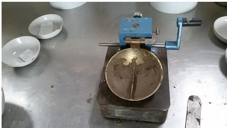
Figure 9 :Appareil de Casagrande
