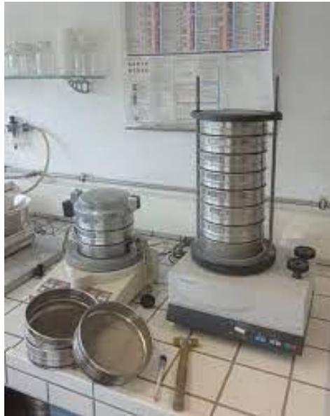
**Figure 7 :Matériel de l'essai granulométrique**
