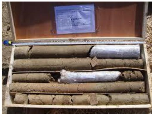
**Figure 6 : Caisse de carotte après prélèvement du sol**
