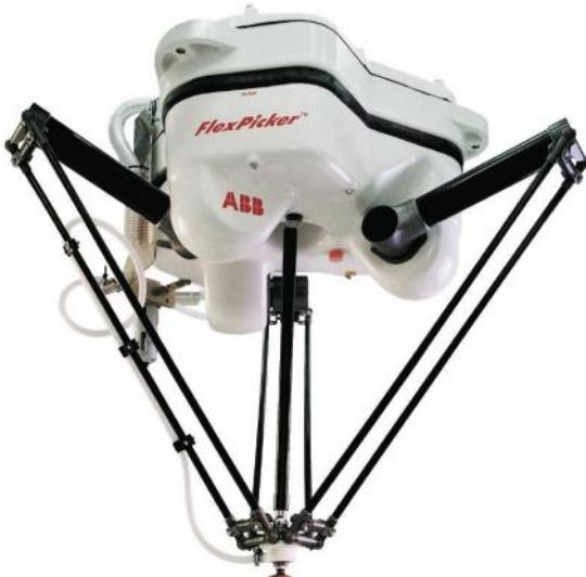
**Figure 1. 3 :** Robot parallèle Delta [7].
